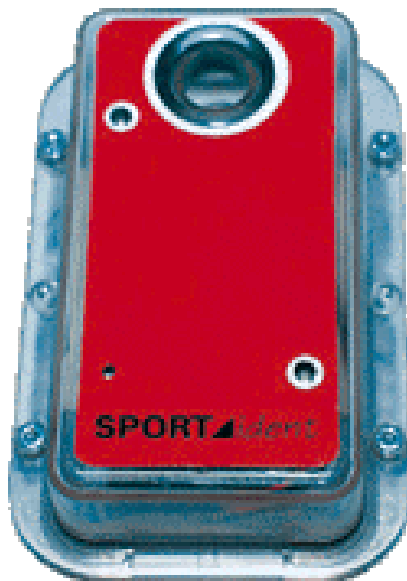
Figur 6: Postenheden til SI-systemet. Brikken stikkes i det store hul øverst. De to små "huller" er lamper som lyser når brikken registreres.
